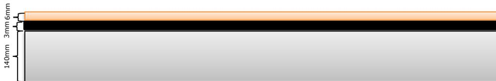
Recubrimiento de piso : Lámina de gránulos de caucho reciclado de neumáticos SBR (butadieno – estireno) de 3 mm de espesor instalado entre una losa de hormigón de 140 mm y un piso laminado de madera de 6 mm de espesor
